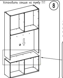
Досверлите 4 отв. Ø8мм (чтобы отверстия получились аккуратными, на выходе сверла подложите брусок ДСП)
